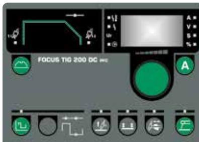
TIG DC řídící panel pro svařování všech kovů mimo hliníku a jeho slitin. Umožňuje též svařování obalenou elektrodou (MMA). Funkce jsou popsány na druhé straně tohoto průvodec.
